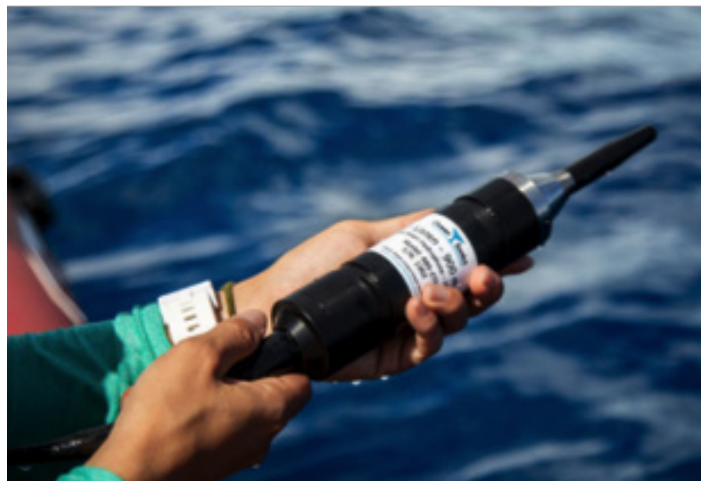
Un chercheur déployant l'hydrophone icListen. Photo : Ocean Sonics
